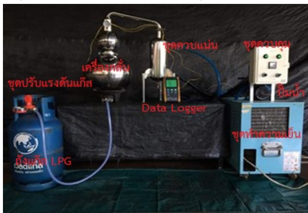
รูปที่ 2 อุปกรณ์การทดลอง และตำแหน่งการวัดอุณหภูมิ
