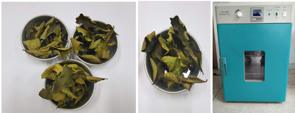
รูปที่ 3 การอบแห้งตัวอย่างใบมะกรูด และตู้อบลมร้อนที่ใช้ในการทดลอง
