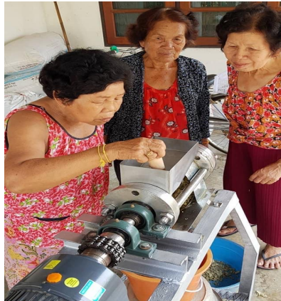
รูปที่ 7 การใช้เครื่องสกัดน้ำมันแบบเกลียวอัดโดยกลุ่มแม่บ้านฯ
