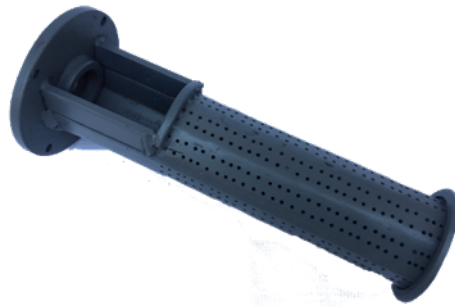
รูปที่ 4 กระบอกอัดของเครื่องสกัดน้ำขิงแบบเกลียวอัด
