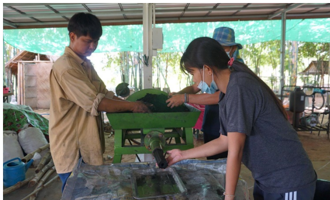
รูปที่ 2 เครื่องอัดถ่านอัดแท่งถ่านแบบสกรูอัด
