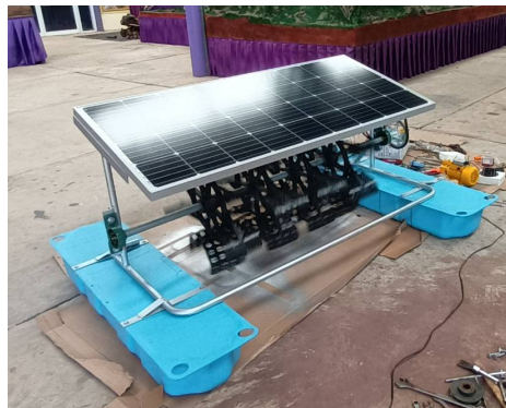
รูปที่ 2 กังหันน้ำพลังงานแสงอาทิตย์ต้นแบบของสำนักงานก่อสร้างชลประทานขนาดเล็ก กรมชลประทานที่ 6
