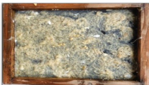
รูปที่ 3 ชิ้นแผ่นกระดาษ ด้วยเฟรม ขนาด 25x25 เซนติเมตร
