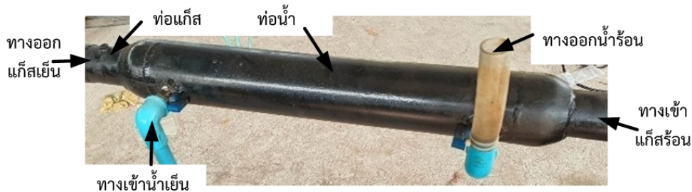
รูปที่ 3 ชุดระบายความร้อนแก๊ส
