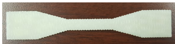
รูปที่ 4 ชิ้นงานพิมพ์สามมิติที่ได้จากระบบการพิมพ์สามมิติด้วยแขนหุ่นยนต์
