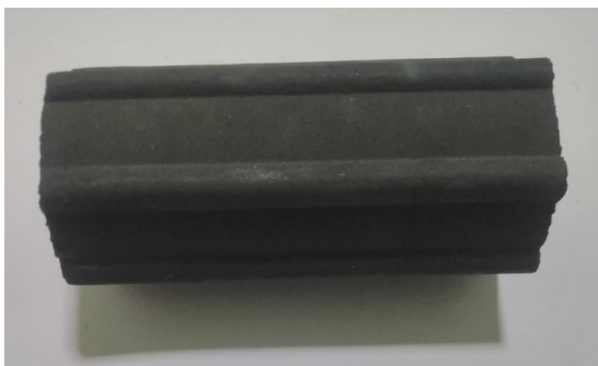
รูปที่ 3 ถ่านอัดแท่งจากไม้ไผ่ขนาด ยาว 10 เซนติเมตร และความกว้าง 5 เซนติเมตร
