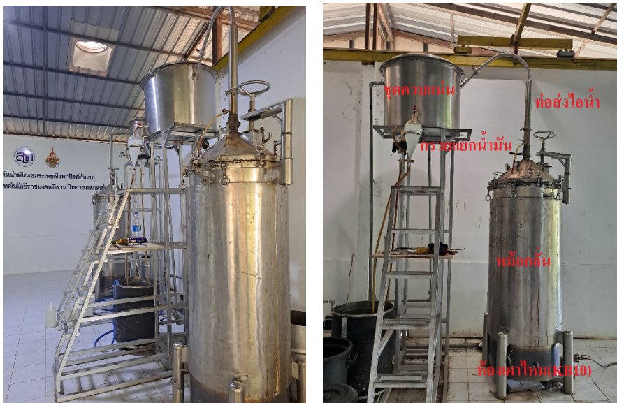
รูปที่ 2 เครื่องกลั่นที่ใช้ในการสกัดน้ำมันหอมระเหยด้วยวิธีการกลั่นด้วยน้ำและไอน้ำ (Water and steam distillation)
