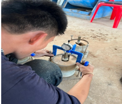
(ก) ติดตั้ง Dial gauge เพื่อวัดการบวมตัวของดิน
