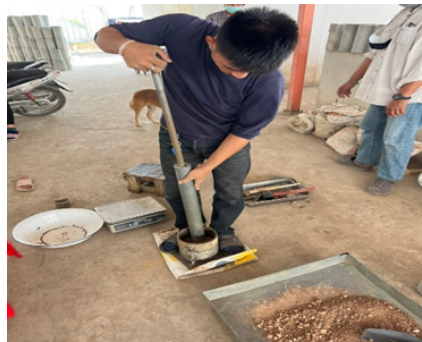
(ค) บดโดยค้อนด้วยวิธี Modified proctor
