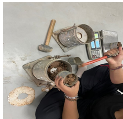
(ง) นำตัวอย่างไปหาค่าเปอร์เซ็นต์ความชื้น
