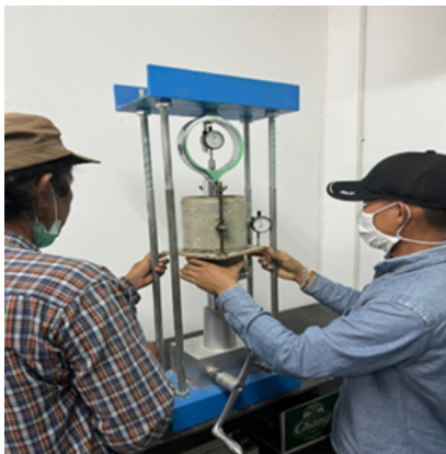
(ค) นำตัวอย่างขึ้นจากน้ำเพื่อนำไปกดวัดค่า Penetration
