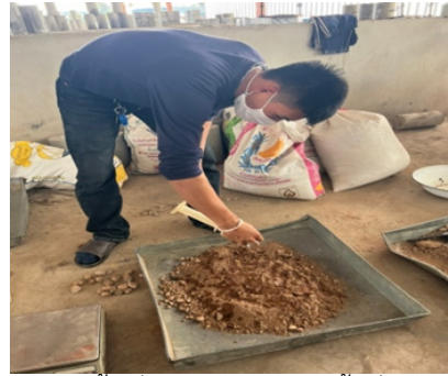
(ข) เติมน้ำเพื่อหาปริมาณความชื้นที่เหมาะสม
