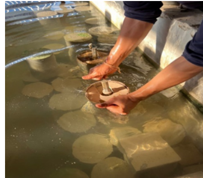
(ข) นำตัวอย่างดินไปแช่น้ำ 4 วัน
