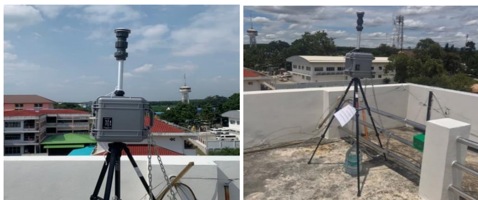
รูป 1 การเก็บตัวอย่างฝุ่น PM_{2.5} ด้วยเครื่องเก็บตัวอย่างฝุ่นละอองปริมาตรต่ำ (Mini volumetric air sampler)
