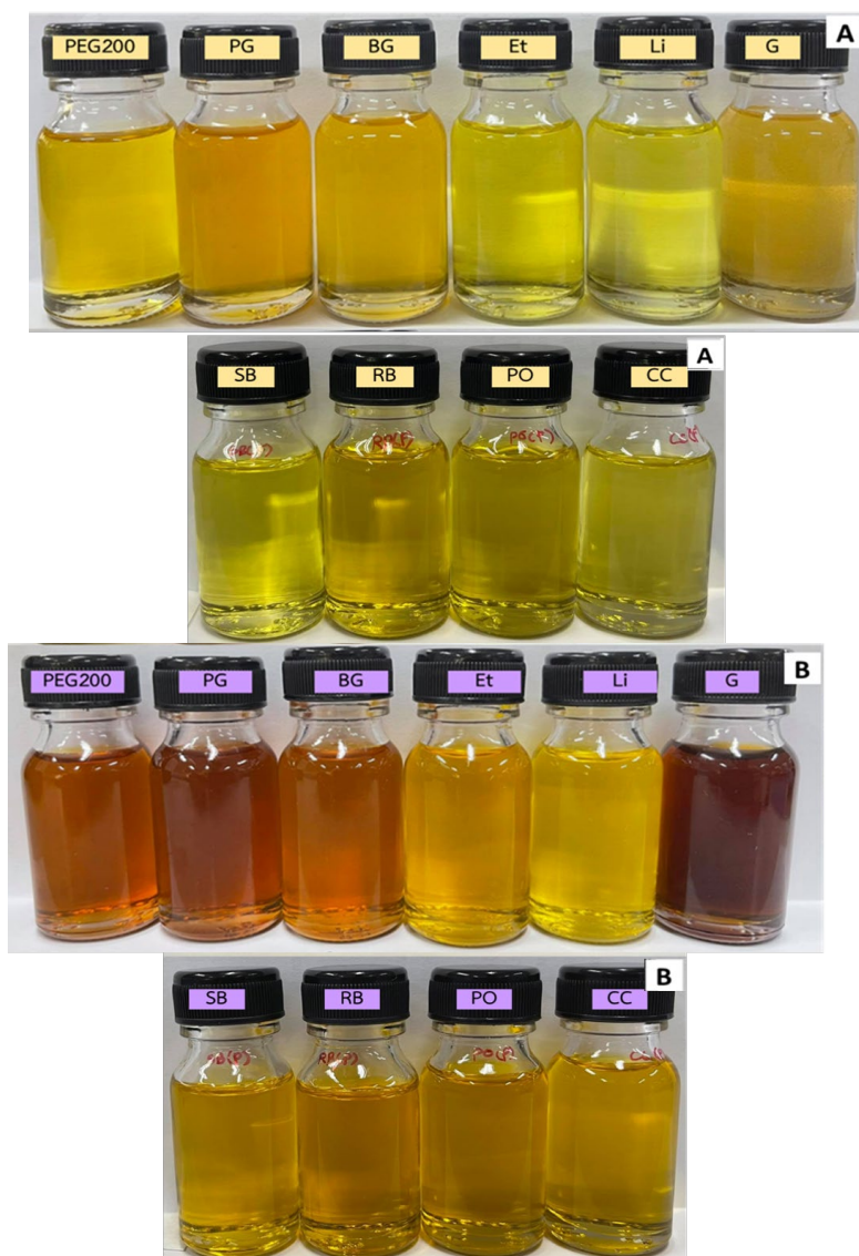
รูป 1 ลักษณะของสารสกัดจากเส้นใยตาล (A) และเปลือกผลตาล (B) ด้วยตัวทำละลายชนิดต่างๆ สกัดด้วยวิธี MAE (โพลีเอทิลีนไกลคอล 200 (PEG200), โพรพิลีนไกลคอล (PG), บิวทิลีนไกลคอล (BG), เอทานอล (Et), ดี-ลิโมนีน (Li), กลีเซอริน (G), น้ำมันถั่วเหลือง (SB), น้ำมันรำข้าว (RB), น้ำมันปาล์ม (PO) และน้ำมันมะพร้าว (CC))
