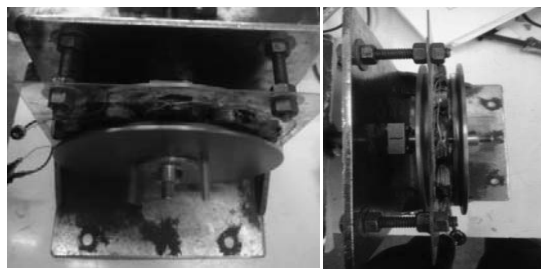
ภาพที่ 12 AFPM Generator ที่สมบูรณ์
