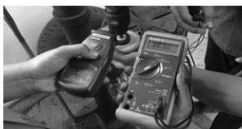
ภาพที่ 6 การวัดรอบจากเทคโคมิเตอร์
