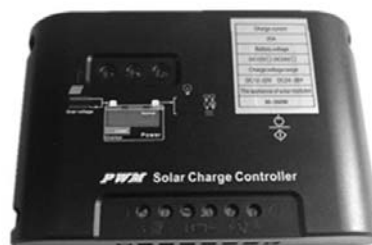
ภาพที่ 8 ชุดควบคุมการประจุพลังงานแบตเตอรี่
