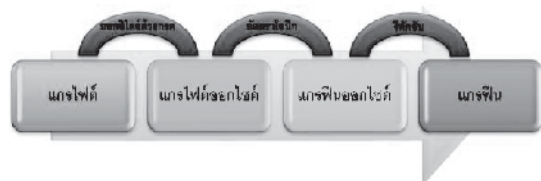
ภาพที่ 6 แสดงขั้นตอนการสังเคราะห์แกรฟีนโดยเริ่มต้นจากแกรไฟต์
