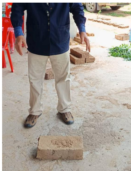
ภาพที่ 7 การทดสอบความแข็งแรงของอิฐบล็อกดินเหนียวปนทราย โดยการปล่อยก้อนอิฐบล็อกจากความสูง 1 เมตร มีการกำหนดจำนวนครั้งในการโยน 3 ครั้ง ในแต่ละสูตร
