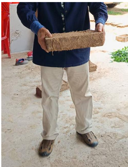
ภาพที่ 7 การทดสอบความแข็งแรงของอิฐบล็อกดินเหนียวปนทราย โดยการปล่อยก้อนอิฐบล็อกจากความสูง 1 เมตร มีการกำหนดจำนวนครั้งในการโยน 3 ครั้ง ในแต่ละสูตร
