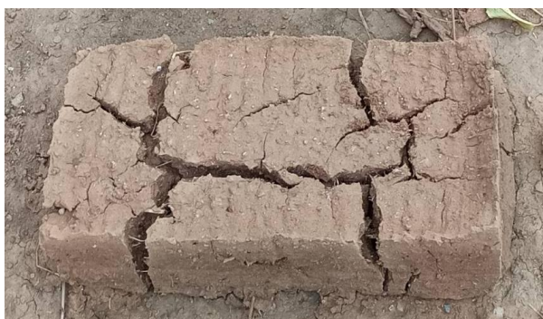
ภาพที่ 6 รอยแตกร้าวของอิฐบล็อกดินเหนียวปนทรายหมักเพียงอย่างเดียวตอนก่อนอิฐบล็อกแห้ง
