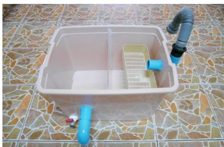
ภาพที่ 2 แสดงลักษณะภาพประกอบด้านบนถังดักไขมัน
