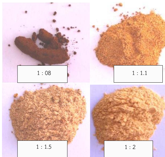
ภาพที่ 4.2 ผลการเติมสารดูดซับชนิดต่าง ๆ ในสารสกัดเห็ดหึ่งเกือกม้าเพื่อให้ได้สารสกัดในรูปผงแห้ง ระหว่างระเหยตัวทำละลายออกด้วยเครื่อง rotary evaporator
