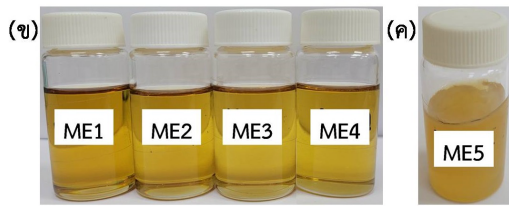
ภาพที่ 2 (ก) แผนภาพวัฏภาคของระบบที่ 12 โดยบริเวณที่แรเงาแสดงพื้นที่ไมโครอิมัลชันและจุดแสดงอัตราส่วนของส่วนประกอบสำหรับเตรียมไมโครอิมัลชันเปล่า (ข) ตำรับที่เตรียมจากจุดที่ 1 2 3 และ 4 หลังผสมกับยาไอทราโคนาโซล (ME1 – ME4) ซึ่งมีลักษณะเป็นของเหลวใส (ค) ตำรับที่เตรียมจากจุดที่ 5 หลังผสมกับยาไอทราโคนาโซล (ME5) ซึ่งมีลักษณะเป็นเจลขุ่น
