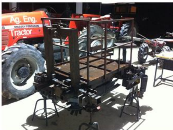
ภาพที่ 4 ผลการสร้างเครื่องปลูกมันสำปะหลังต้นแบบ
