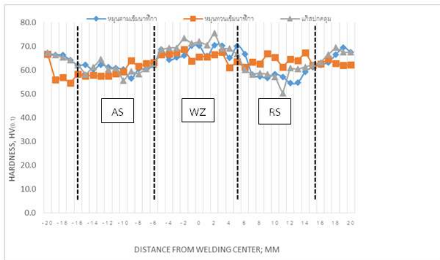
ภาพที่ 9 ค่าความแข็งแนวเชื่อมของชิ้นงานเชื่อม
