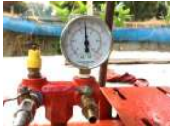
ภาพที่ 10 แสดงความดันอากาศในถังลมในระบบปิด
