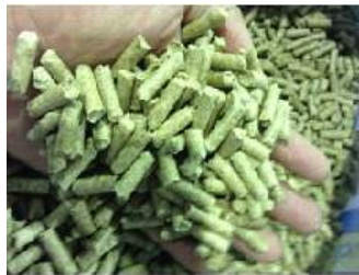
ภาพที่ 5 ชีวมวลอัดแท่งจากเครื่องแบบ D-type
