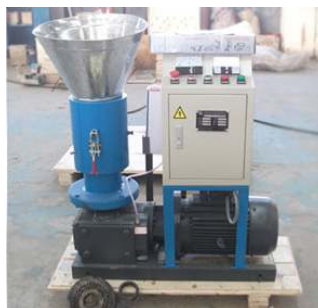
ภาพที่ 3 เครื่องผลิตชีวมวลอัดแท่งแบบ R-type รุ่น ZLSP 400B
