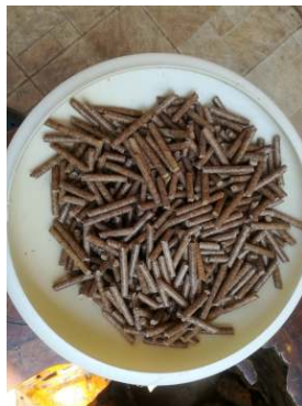
ภาพที่ 6 ชีวมวลอัดแท่งจากเครื่องแบบ R-type
