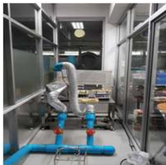
ภาพที่ 1 ชุดควบคุมความชื้นสัมพัทธ์และอุณหภูมิ (Sookchaiya, Monyakul & Thepa, 2010)
