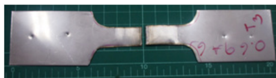
ภาพที่ 8 ชิ้นงานหลังจากทดสอบแรงดึง
