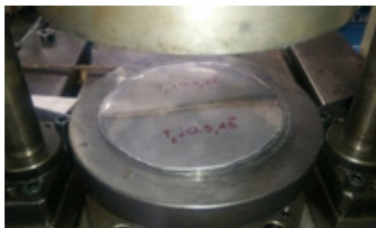
ภาพที่ 9 แผ่นชิ้นงานวางบนแม่พิมพ์
