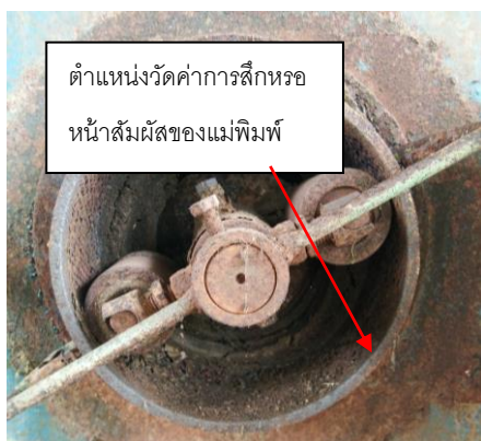
ภาพที่ 5 Position for measuring wear of mold.
