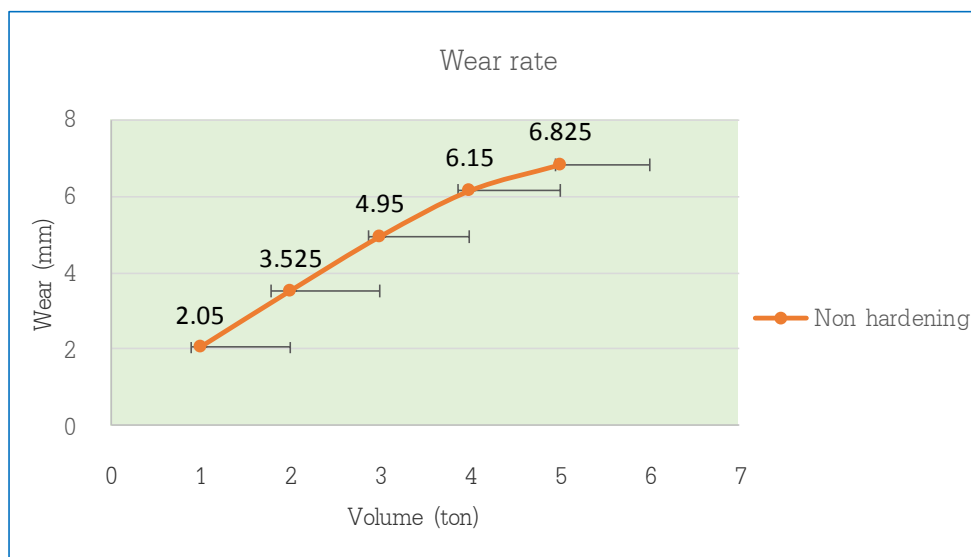
ภาพที่ 6 An error bar for wear rate of the mold non hardening.
