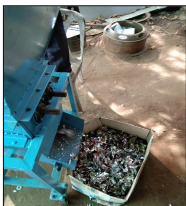
ภาพที่ 7 แสดงลักษณะกระป๋องอลูมิเนียมที่ผ่านการย่อยจากเครื่องย่อยกระป๋องอลูมิเนียม
