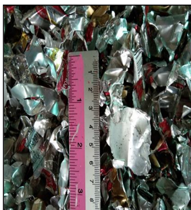
ภาพที่ 7 แสดงลักษณะกระป๋องอลูมิเนียมที่ผ่านการย่อยจากเครื่องย่อยกระป๋องอลูมิเนียม
