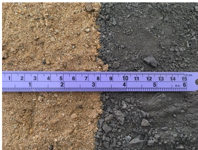
ภาพที่ 2 ภาพถ่ายเปรียบเทียบขนาดเม็ด (grainsize) ระหว่างทราย และ หินฝุ่นบะชอลต์ที่ไม่ได้คัดขนาด
