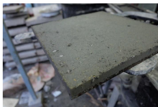
ภาพที่ 4 แผ่นใยอัดซีเมนต์จากเส้นใยผักตบชวา
