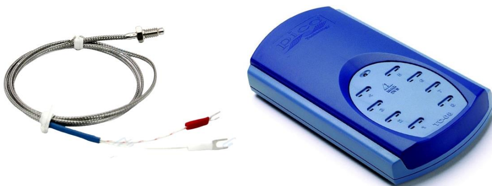
ภาพที่ 2 สายเทอร์โมคัปเปิล Type K และ Data logger Type K ที่ใช้ในการทดลอง
