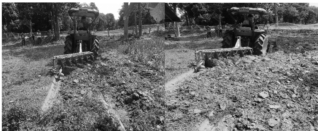
ภาพที่ 6 ตัวอย่างหลังการทดสอบการไถกลบวัชพืชที่ได้จากการใช้พารามิเตอร์จาก RSM-MDE
