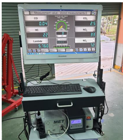
ภาพที่ 3 เครื่องมือวัดก๊าซมลพิษ (Gas analyzer)
