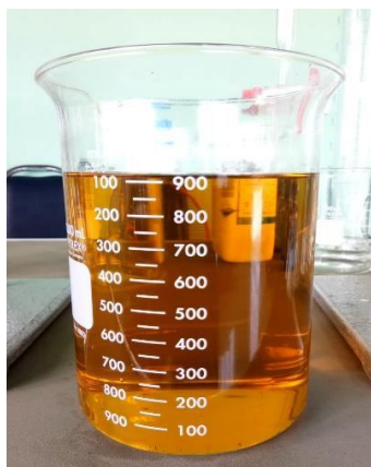
ภาพที่ 4 เชื้อเพลิงปาล์มไบโอดีเซล
