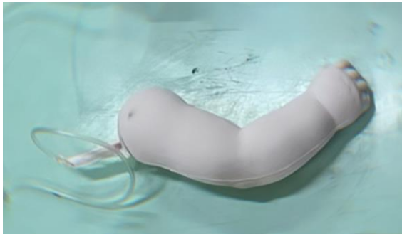
ภาพที่ 4 หุ่นต้นแบบใส่สายเพื่อเป็นการใส่ลมและระบายลม (เสมือนน้ำยาที่ฉีด)
