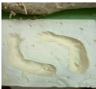
ภาพที่ 2 แม่พิมพ์เบ้าหุ่นต้นแบบ
