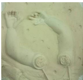
ภาพที่ 4 หุ่นต้นแบบใส่สายเพื่อเป็นการใส่ลมและระบายลม (เสมือนน้ำยาที่ฉีด)
