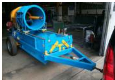
ภาพที่ 12 เครื่องปอกเปลือกต้นสาकु
