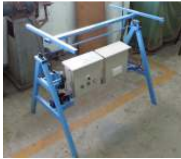
ภาพที่ 2 โครงสร้างเครื่องป้องกันแผงเซลล์แสงอาทิตย์ปรับมุมได้ 5 มุม
