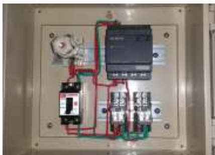
ภาพที่ 4 วงจรควบคุมการปรับมุมแผงเซลล์แสงอาทิตย์
