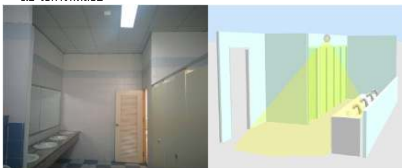
ภาพที่ 6 ตำแหน่งการวางเซนเซอร์และรัศมีระยะตรวจจับ
