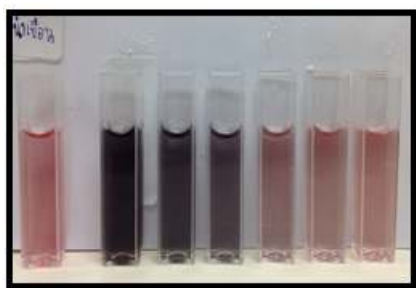
ภาพที่ 8 การตอบสนองของแอนโทไซยานินจากกระเจี๊ยบแดงกับไอออนเหล็กในน้ำเชื่อม
