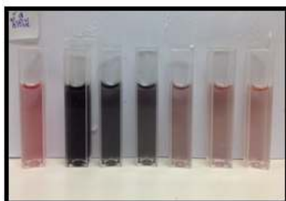
ภาพที่ 7 การตอบสนองของแอนโทไซยานินจากกระเจี๊ยบแดงกับไอออนเหล็กในน้ำดื่ม
