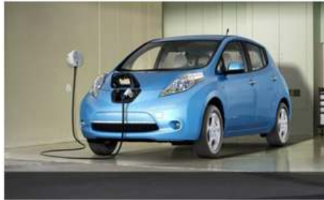
ภาพที่ 2 การประจุแบตเตอรี่แบบปกติที่มีการติดตั้งภายในบ้านพักอาศัย ที่มา: ยศพงษ์ ลอนวล และคณะ (2558)
