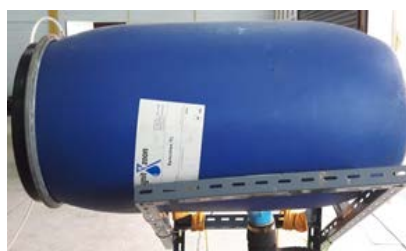
ภาพที่ 6 ด้านข้างของถังพักอากาศ
