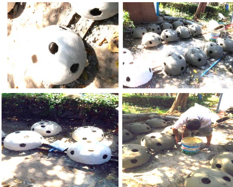
ภาพที่ 6 ปะการังที่ออกมาจากเตาเผาโดยนำมาตกแต่งผิวและนำมาตากแดด
