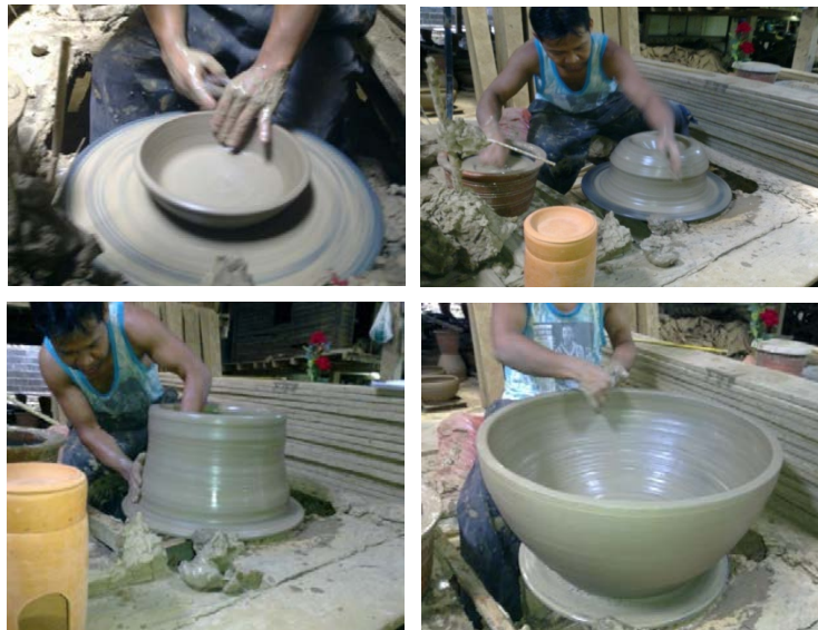
ภาพที่ 4 กระบวนการขึ้นรูปปะการังเทียม
