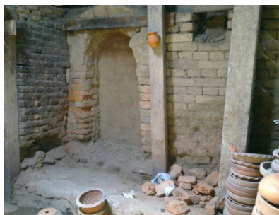
ภาพที่ 5 การเผาโดยใช้ความร้อนประมาณ 800 - 1,000 องศาเซลเซียส
