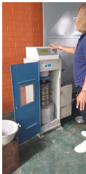
ภาพที่ 6 แสดงเครื่องทดสอบด้วยแรงดึงและแรงกด (Universal Testing Machine)
