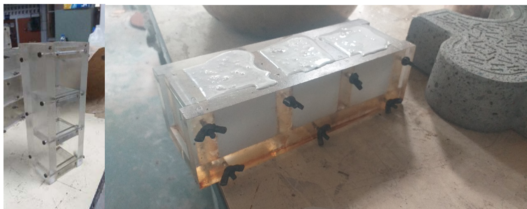
ภาพที่ 7 แสดงวัสดุที่ถูกกดอัดลงแม่แบบขนาด 5 x 5 x 5 เซนติเมตร
