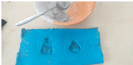
ภาพที่ 13 แสดงแม่พิมพ์จากดินน้ำมันเพื่อขึ้นรูป
