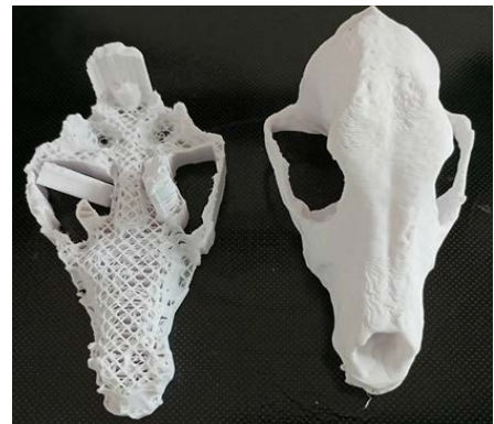
ภาพที่ 11 การถอดชิ้นงานออกจากฐานพิมพ์ ได้ชิ้นงานแบบจำลอง 3 มิติ
