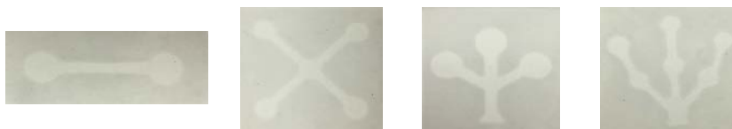
ภาพที่ 2 อุปกรณ์ตรวจวัดบนกระดาษที่ประดิษฐ์ขึ้นทั้ง 4 แบบ
