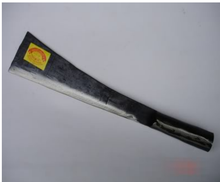
รูปที่ 1 ลักษณะชิ้นงานเหล็กกล้าคาร์บอนต่ำที่ผ่านการขึ้นรูปเป็นมีดสำหรับการทดลอง
