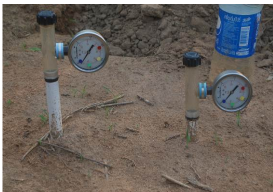
ภาพผนวกที่ 3 ค่าที่อ่านจากเครื่องวัดแรงดึง ความชื้นได้ที่ 0 ทั้ง 2 ระดับ (ฝังลึกที่ระดับ 30-55 เซนติเมตร) ดินอิมตัวด้วยน้ำ
