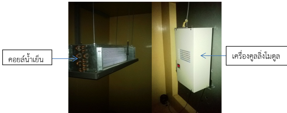
ภาพที่ 3 การติดตั้งอุปกรณ์และเครื่องมือวัดในห้องควบคุมสภาวะอากาศภายนอก
