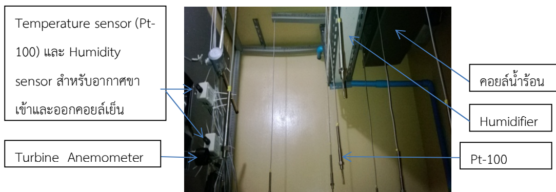
ภาพที่ 2 การติดตั้งอุปกรณ์และเครื่องมือวัดในห้องควบคุมสภาวะอากาศภายใน
