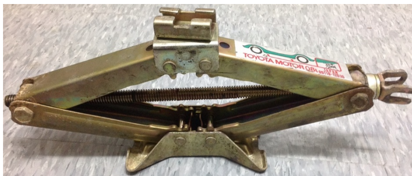
ภาพที่ 8 แม่แรงมาตรฐานที่ติดมากับรถยนต์
