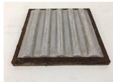
ภาพที่ 6 ชิ้นงานตัวอย่างที่ขึ้นรูปเป็นแผ่นมุงหลังคา
