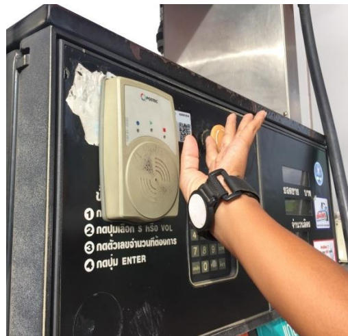
ภาพที่ 4 ตัวอย่างการใช้แท็กเพื่อให้ตู้จ่ายน้ำมันทำงาน
