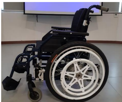
ภาพที่ 4 วีลแชร์ที่ติดตั้งคัมล้อทดแรง
