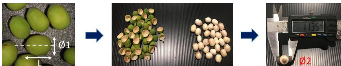
ภาพที่ 1 การวัดความหนาเปลือกเมล็ดบัว
