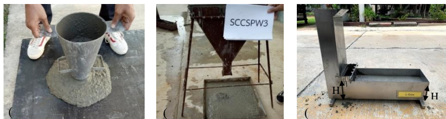
ภาพที่ 3 การทดสอบคอนกรีตสด (ก) การทดสอบการไหลแผ่ (Slump flow)
