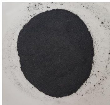
ภาพที่ 1 เถ้าลอยจากโรงงานสกัดน้ำมันปาล์ม
