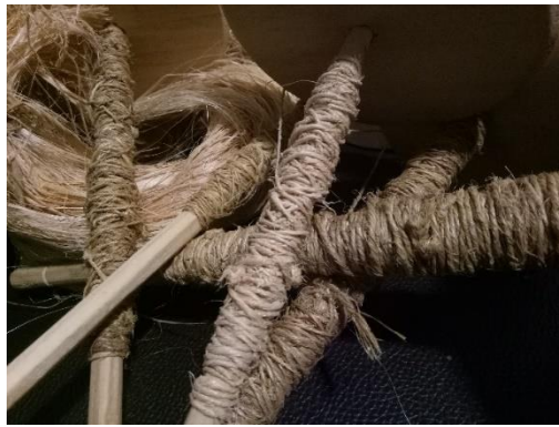
ภาพที่ 3 เชือกกล้วยที่ผ่านกระบวนการเข้าเกลียวเชือกด้วยเครื่องปั่นเส้นใยแบบมือหมุน
